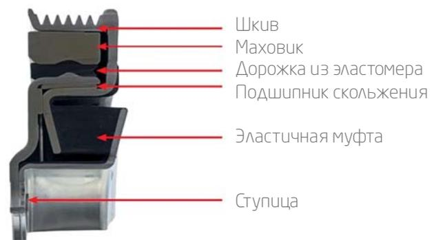
Рис. 1. Многослойная конструкция демпферов крутильных колебаний шкива коленчатого вала
