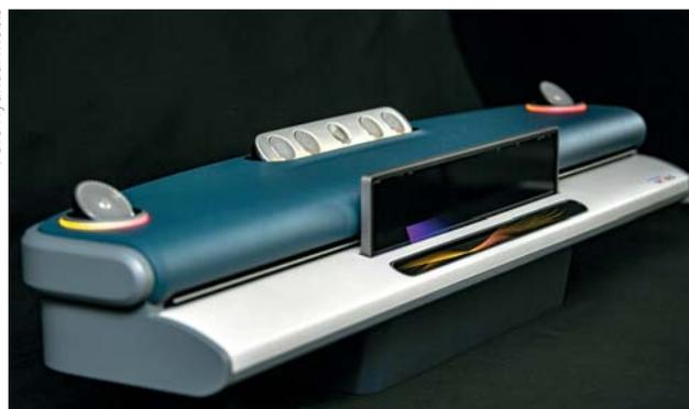
наслаждаться музыкой и видео, когда автомобиль неподвижен или движется в автономном режиме без участия водителя. В этот момент подвижная звуковая система направляет звук на лобовое стекло автомобиля. Дисплей разворачивается лишь на треть от своего размера во время движения, чтобы обеспечить достаточный обзор водителю, отображается минимум информации о вождении. В это время динамики ориентируются на водителя.
