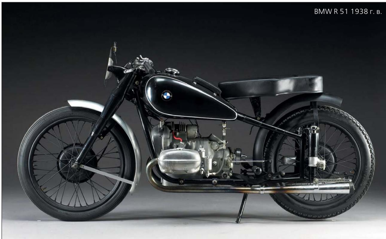
В начале 1934 года Фалькенхаузен стал штатным гонщиком BMW в мотокроссе, а вскоре вошел и в конструкторскую группу. Уже на следующий год баварцы начали использовать телескопическую переднюю вилку, а в 36-м – заднюю подвеску свечного типа. Эти нововведения не только позволили выиграть множество заездов, но и нашли применение на серийных моделях. Впервые в истории оба элемента конструкции объединились на мотоциклах BMW, поступивших в продажу в 1938 году.
