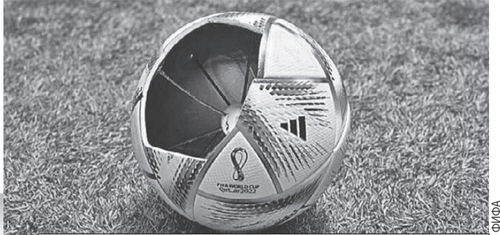
В центре сферы расположен датчик, который показывает не только положение мяча на поле, но и силу удара по нему.
