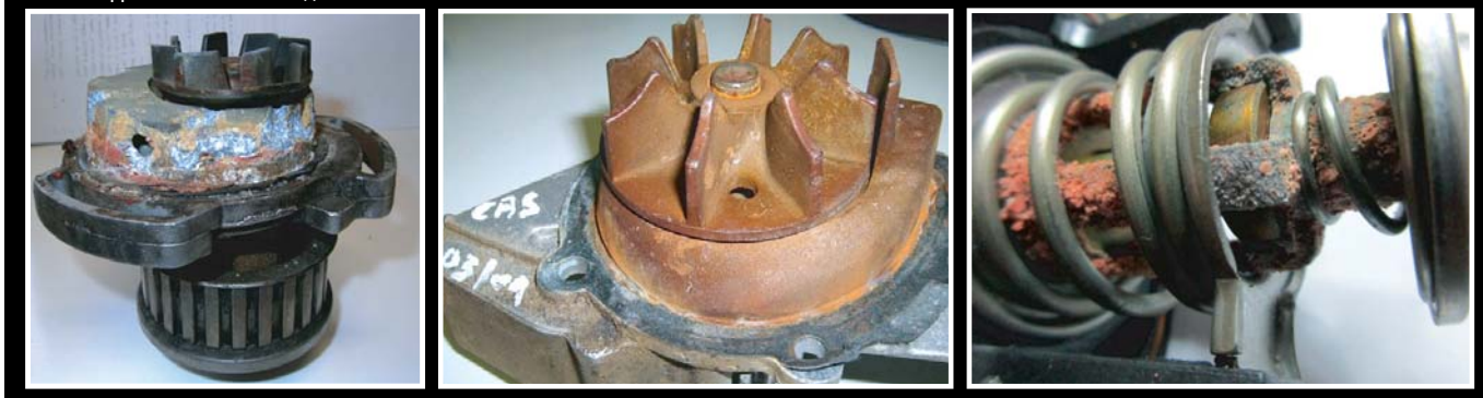
Рис. 2: Коррозия системы охлаждения
