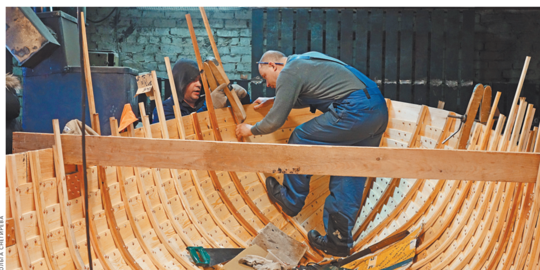
На верфи «Варяг» строят уникальные деревянные суда по классическим технологиям.
