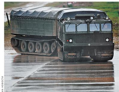
Арктический двухзвездный транспортер ДТ-10ПМ может двигаться со скоростью до 44 км/ч по суше и до 6 км/ч на плаву.
