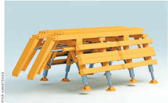
Такая роботизированная «многоножка» является платформой для добычи угля без участия человека.
