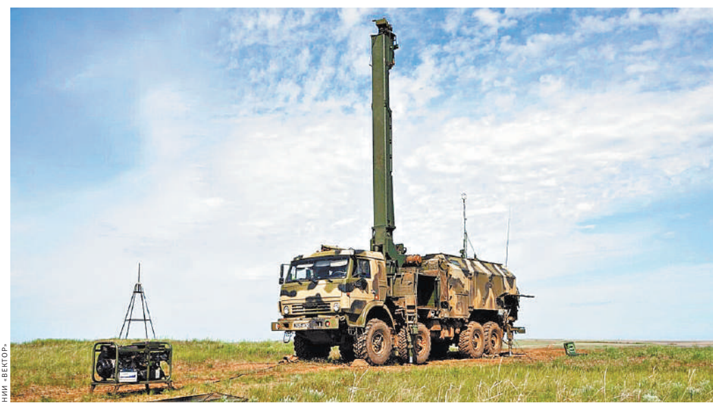
На самоходном шасси комплекса установлены оптико-электронные модули и акустические приемники.
