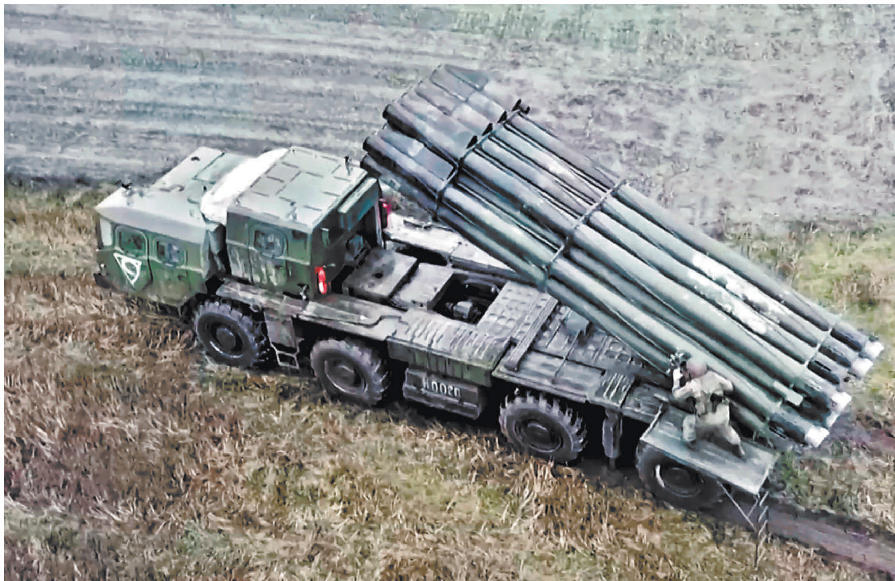
Большая дальность полета и малый коэффициент отклонения 300-мм снарядов позволяют расчетам РСЗО «Смерч» поражать важные объекты в тылу противника.
