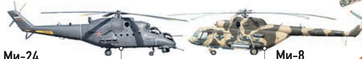
Ми-8 (по классификации НАТО — Hip — «Бедра»), самый массовый двухдвигательный вертолет в мире. Экипаж — 3 человека. Дальность до 715 километров, с дополнительными баками — 1300 километров, максимальная взлетная масса — 13 тонн. Максимальная скорость — 270 километров, число десантников — 27 человек. Может нести на себе контейнеры с вооружением.
