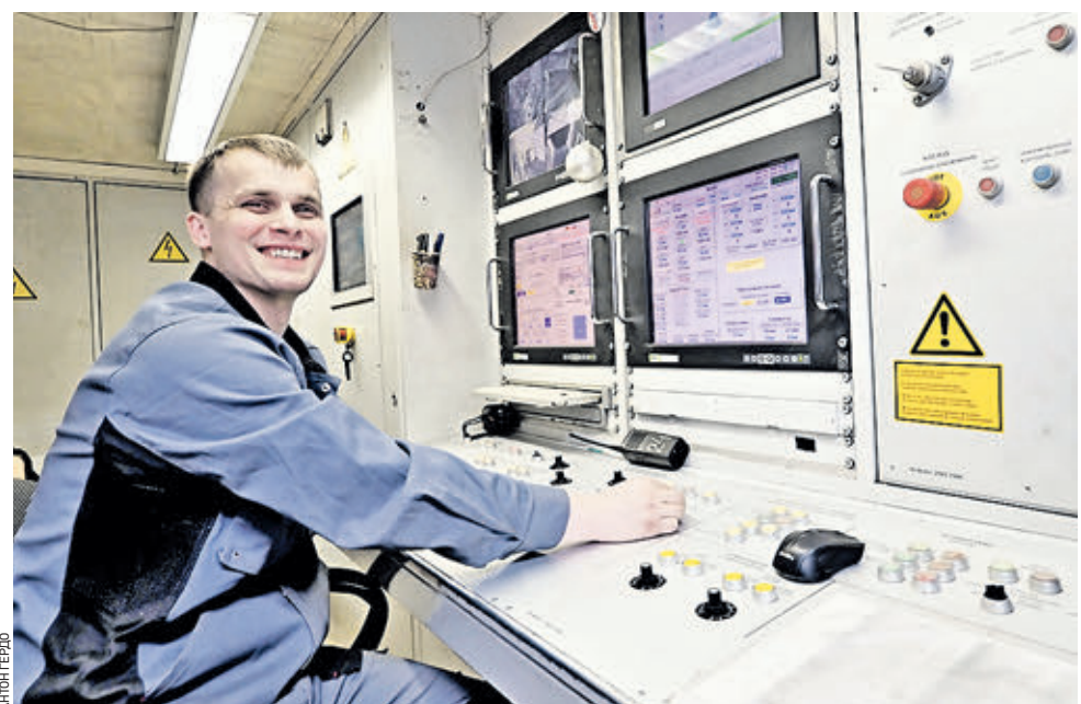
21 февраля 2019 года 12:30 Машинист 6-го разряда Александр Сокол управляет тоннелепроходческим механизированным комплексом (ТПМК «Виктория»), который задействован на проходе тоннеля от станции «Стахановская» Некрасовской линии метро до «Нижегородской». Александру уже 9 лет управляет различными проходческими щитами, чем и заслужил 6-й разряд, позволяющий работать на ТПМК «Виктория»
